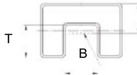
4. Nutrohr oval 80x40mm 1.5mm dick, Nut BxT mm 27x30mm, mit Alu-Kantschutzprofil 23x24mm dicke 1.5mm
