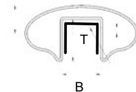
Nutrohr, geschliffen V2A / V4A
